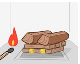
1. Luftzufuhr öffnen 2. Befehungselement unter dem Scheitholz positioniert 3. Zündmittel entzünden
