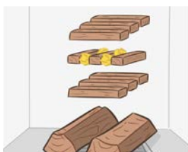
1. Luftzufuhr öffnen 2. Befehungselement auf dem Scheitholz positioniert 3. Zündmittel entzünden
