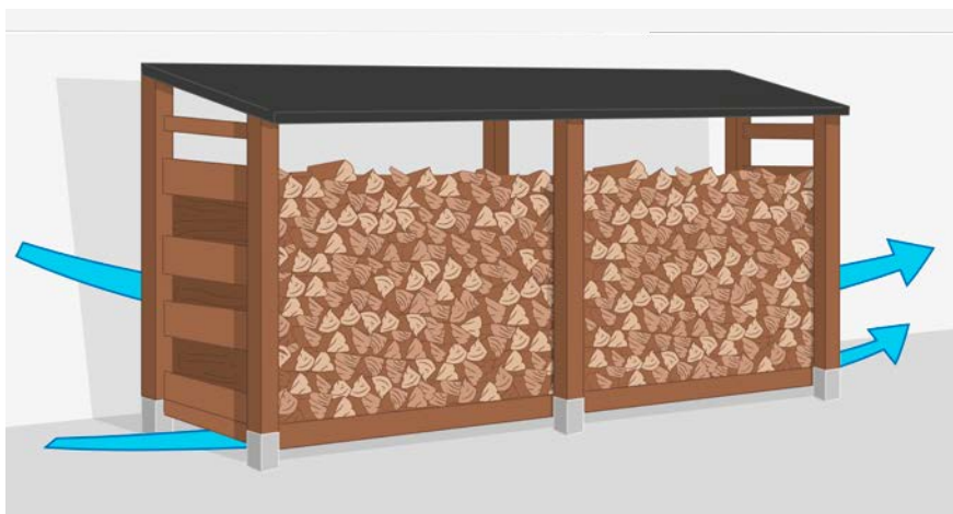
Das Holz wird überdacht und mit Abstand vom Boden gelagert.
